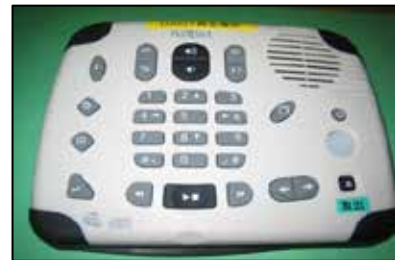
DAISY図書再生機 （活字や写真、グラフや表など図書にあるすべての情報を音声にしてCD-Rに録音したDAISY図書を再生する専用再生機です。）
